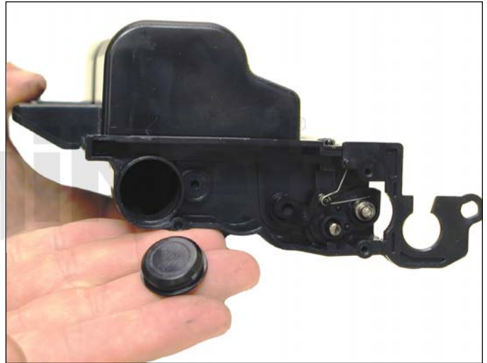
10. En la cavidad de suministro, remueva el tapón de llenado y elimine el tóner de desperdicio.
