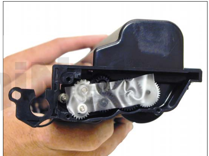
11. Remueva el engranaje guía del rodillo revelador y coloque un pedazo de cinta adhesiva a través del engranaje restante.
