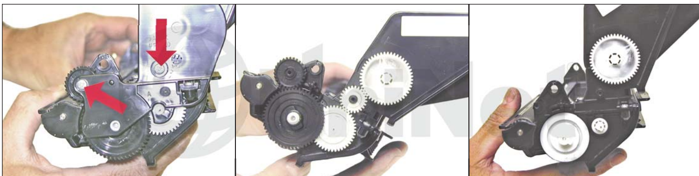
16. En el lado opuesto del tapón de llenado, remueva los dos tornillos, la cubierta lateral y los engranajes como se muestra.
