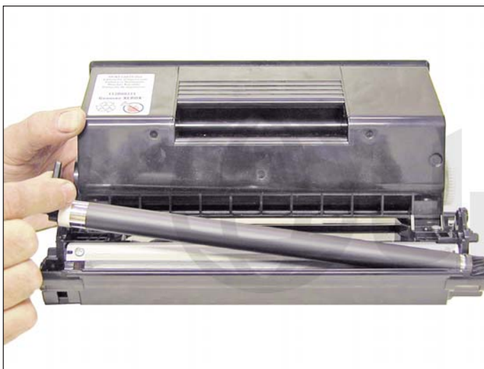
28. Limpie el ensamble del rodillo magnético con un limpiador especial para rodillos magnéticos. Instale primero el lado izquierdo del ensamble (eje circular) asegúrese que el brazo de seguro este asegurado firmemente en su sitio.
