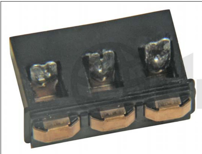
6. Conector con el chip extraído.
