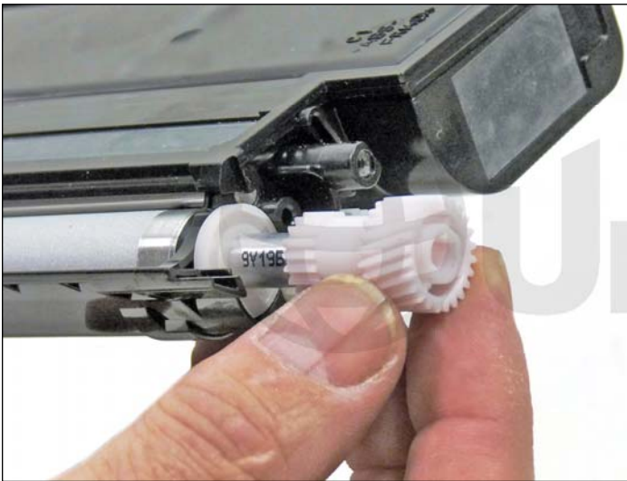
9. Remueva el engranaje guía grande del rodillo magnético.
