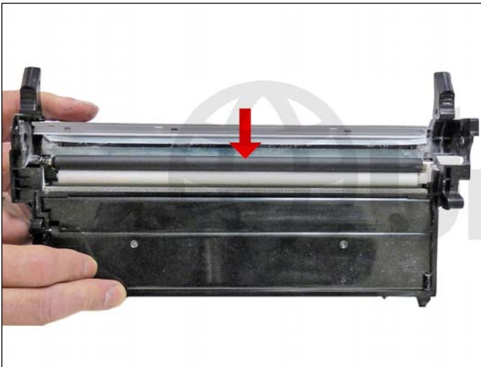
35. Instale el PCR limpio. Coloque una pequeña cantidad de grasa conductiva en el lado negro del soporte.
