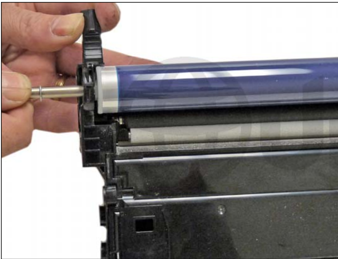
37. Instale el eje del cilindro del lado de la cavidad.
