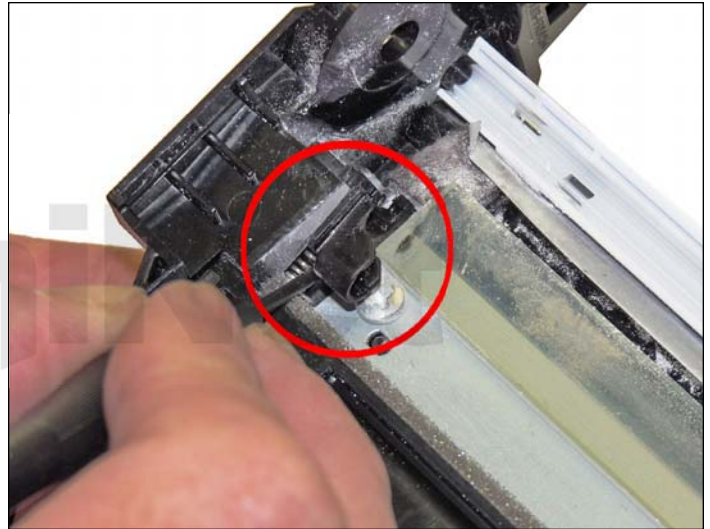
28. Remueva los dos soportes del PCR y los soportes del rodillo de limpieza del PCR. Cuidadosamente levántelos de los lados. Límpielos con hisopo de algodón con alcohol.
