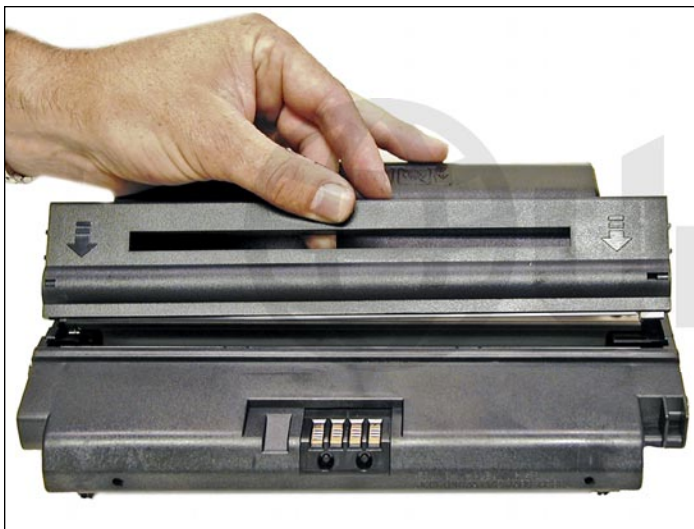
34. Instale la cubierta del ensamble del rodillo de limpieza del PCR limpio.
