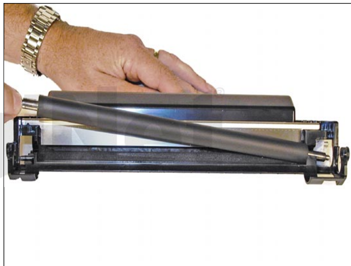
18. Limpie e instale el rodillo revelador, primero el lado largo del eje hacia el lado del engranaje.
