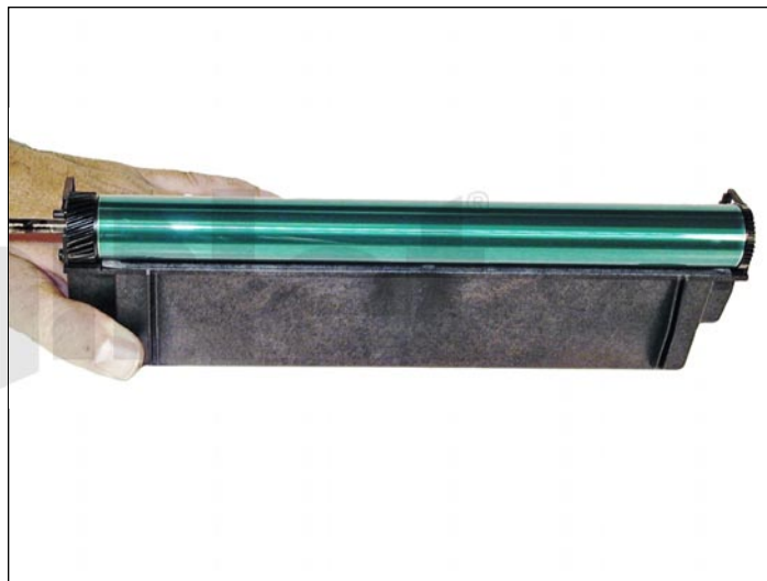
23. Deslice el eje del cilindro afuera del lado opuesto del anillo-E.
