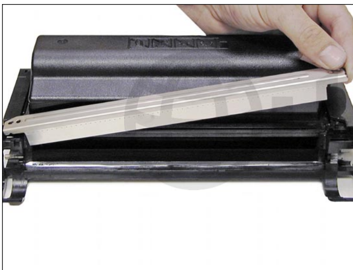
15. Cuidadosamente levante la cuchilla dosificadora. Esta cuchilla está muy ajustada, así que trabájela con mucho cuidado. Limpie el tóner de desperdicio de la cavidad.
