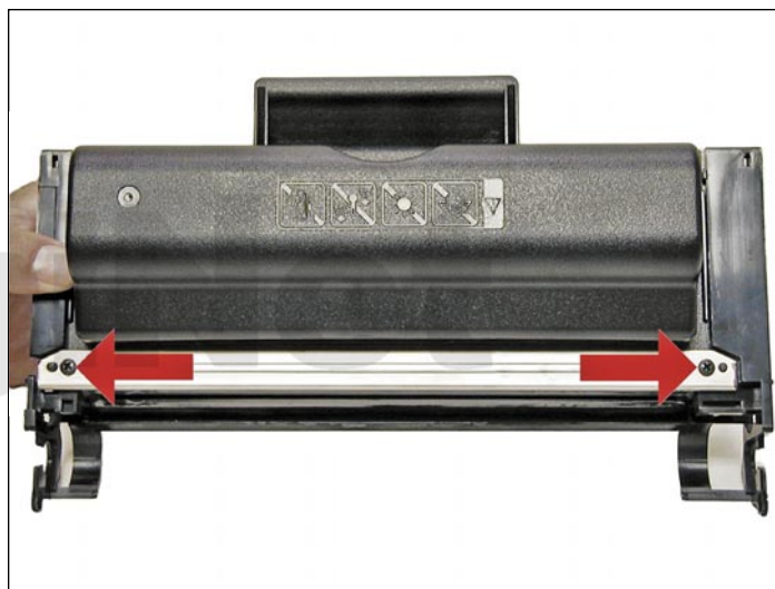
14. Remueva los dos tornillos de la cuchilla dosificadora.
