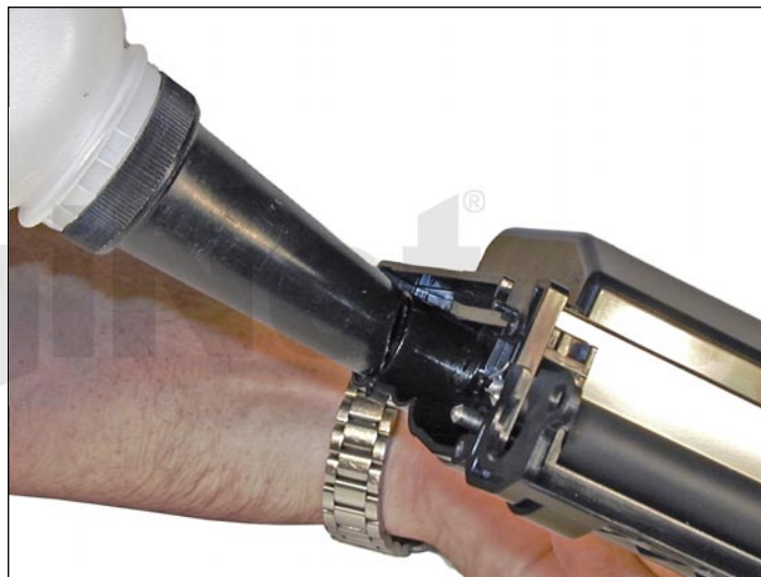
21. Llene la cavidad con 135g o 290g de tóner para uso en Xerox WorkCentre 3550. Revise que no haya escurrimientos
