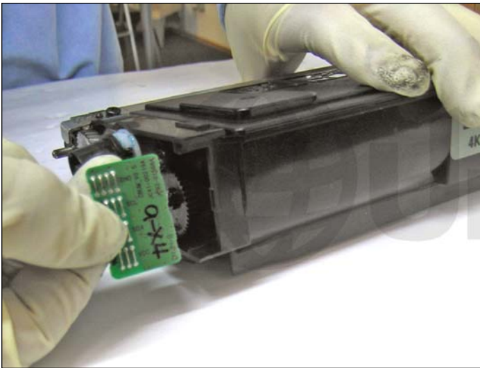
11. Remova o chip, como mostrado. Será substituído por um novo Smartchip ao final da remanufatura.
