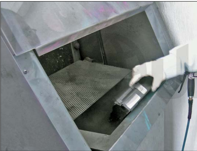
19. Agite levemente o cartucho para retirar o toner restante.
