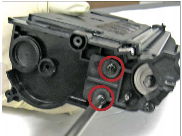
6. Remova os dois parafusos de fixação do rolo revelador do lado sem engrenagem do cartucho.
