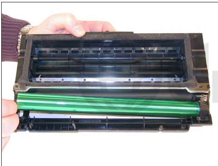
19. Instale el cilindro nuevo en su sitio.
