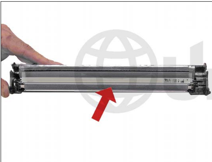
15. Sople o aspire el PCR. Instale la cavidad de desperdicio.
