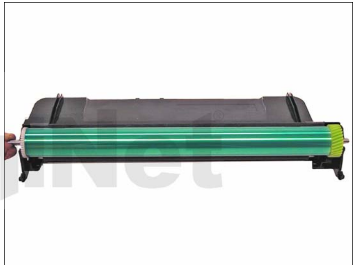
18. Instale el cilindro por el eje del lado del engranaje pequeño primero en la cavidad de desperdicio. Asegúrese que el lado angulado del eje este del lado del engranaje grande.
