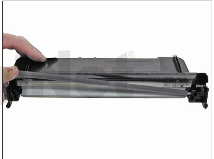
9. Remueva el rodillo de limpieza del PCR. Limpie el PCR con su limpiador normal de PCR.
