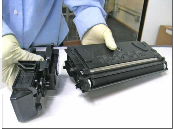
2. Reposito de desperdicios separado.
