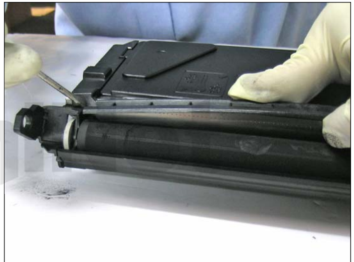
4. Por medio de un desarmador plano, descalce la tapa de la cuchilla de dosificación desde uno de los lados del cartucho como se muestra.
