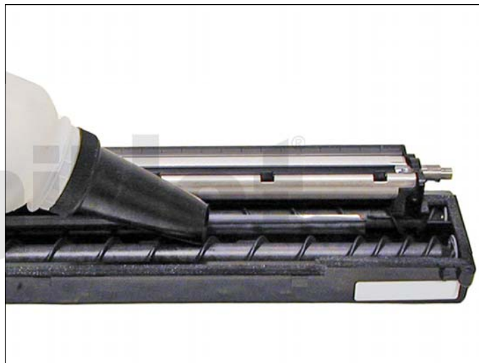
22. Coloque el revelador nuevo.
