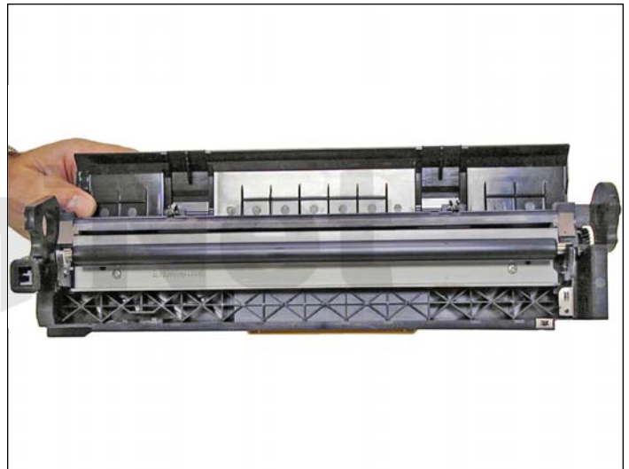
13. Limpie el PCR con su limpiador normal. Limpie la grasa conductiva del eje y coloque grasa nueva. Reinstale el PCR en el ensamble el lado engrasado hacia el soporte negro del PCR.
