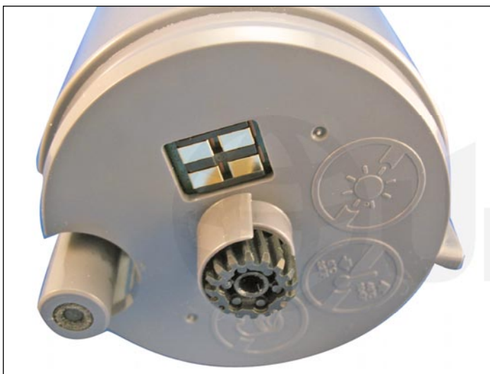
3. Fondo del cartucho mostrando su chip, engranaje del eje de agitación y boquilla de salida de tóner.
