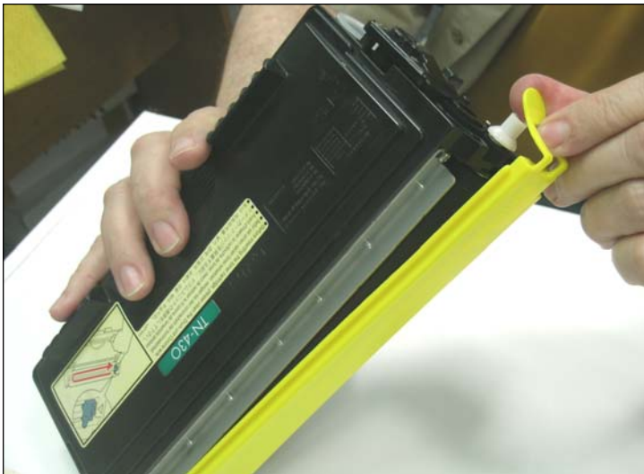
11. Utilizando el sello de viaje original o compatible color amarillo proteger el rodillo de revelado de cualquier daño.
