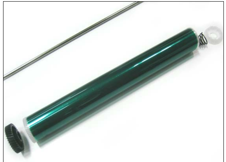
22. Guardar las tres piezas pues serán necesarias al ensamblar el cartucho aun con recambio de cilindro.
