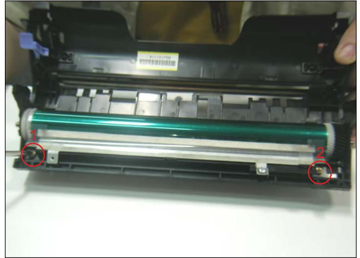
16. Usar un desarmador Phillips y retirar los dos tornillos que sujetan el ensamble de limpieza del cilindro. Se notara que esta compuesto de un fieltro de limpieza, lamina de recuperación y dos raspadores.
