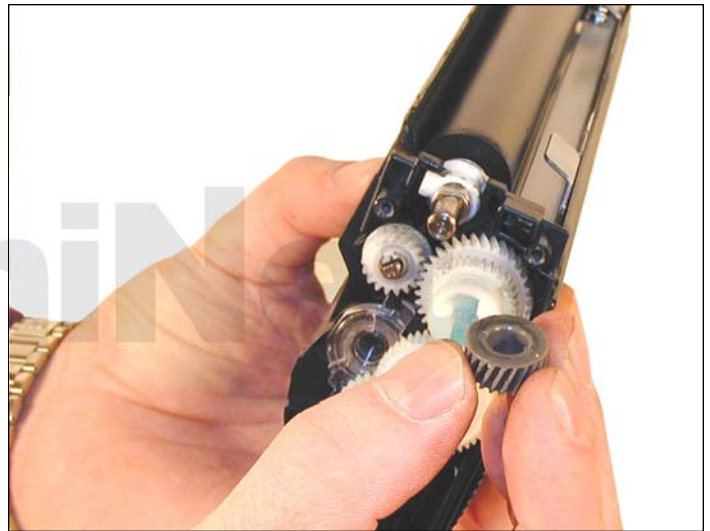
8. Retire el reten tipo "E" y el engranaje pequeño.
