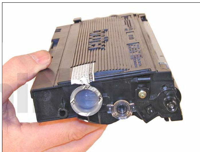
19. Reemplace el tapón de llenado y limpie el cartucho para retirar cualquier residuo de tóner.
