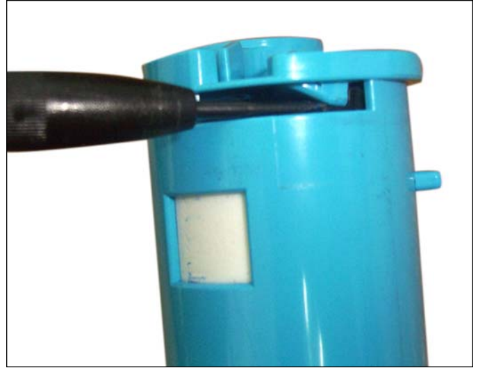
2. Por medio de un desarmador plano pequeño levantar la lengüeta de traba por arriba del taco de bloqueo. Esto permitirá girar la pieza del extremo en sentido anti horario. (La tapa en el extremo del cartucho tendrá colores diferentes dependiendo del modelo de cartucho).
