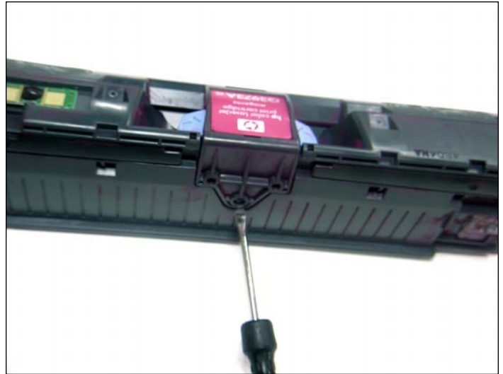
12 Con un desarmador plano pequeño destrabar la tapa de la cuchilla como se muestra.
