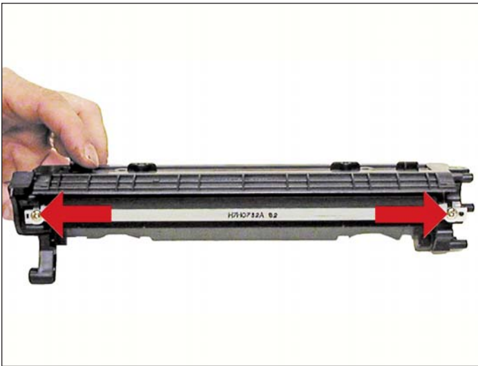
21. Montar la cuchilla dosificadora con sus dos tornillos.
