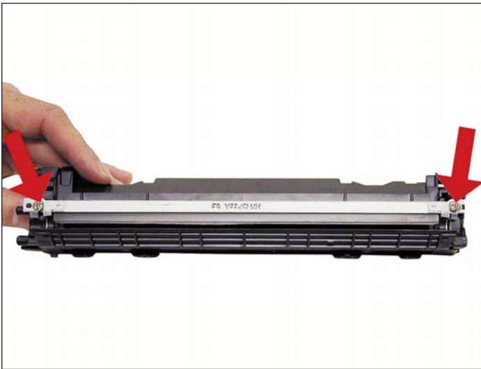
16. Retirar la cuchilla dosificadora y sus dos tornillos.
