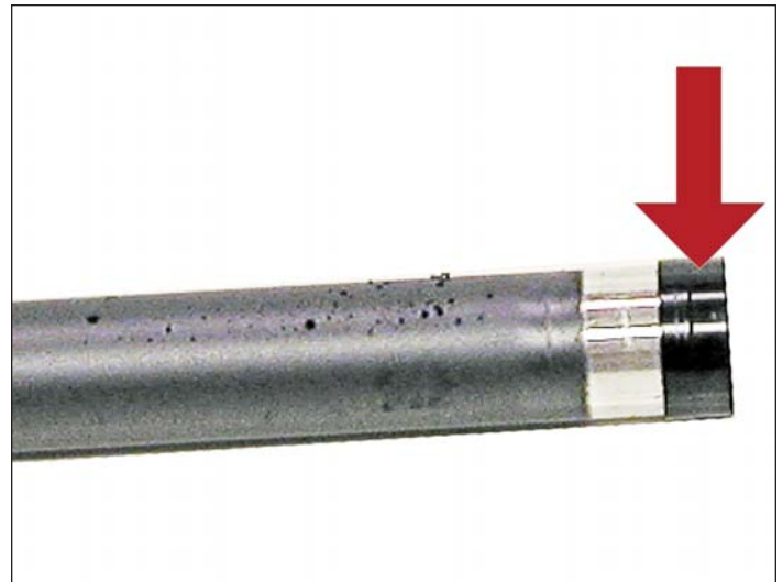
15. Retirar el conjunto de rodillo magnético. Ser precavido con los bujes pues son frágiles.
