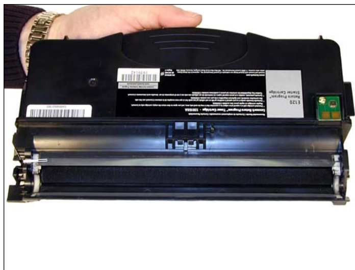
15. Limpie cualquier residuo de t  n de la cavidad. Aseg  rese de que la cuchilla de retenci  n del rodillo revelador no se da  e.
