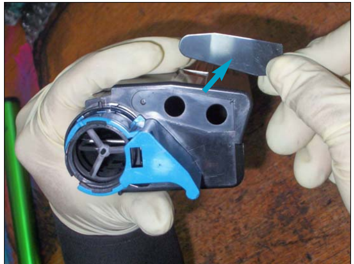
28. Utilizando una aguja delgada o una herramienta de gancho, retire la tapa adhesiva de plástico que cubre la apertura del depósito de pérdida (dos aperturas) mostrado. En este depósito se acumula el toner no utilizado.
