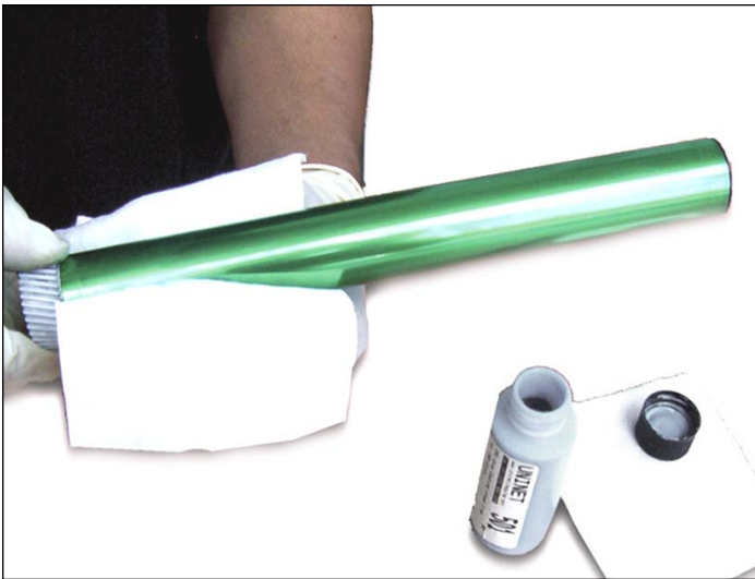
19. Aplicar la "OPC Drum Coating Cream" #501 de Uninet para preservar el cilindro OEM.
