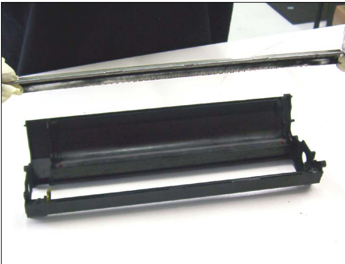
23. Cuchilla de limpieza fuera del cartucho.
