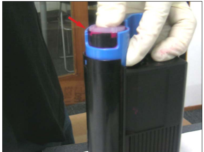
32. Ubicar la tapa para que coincida la lengüeta con la ranura.
