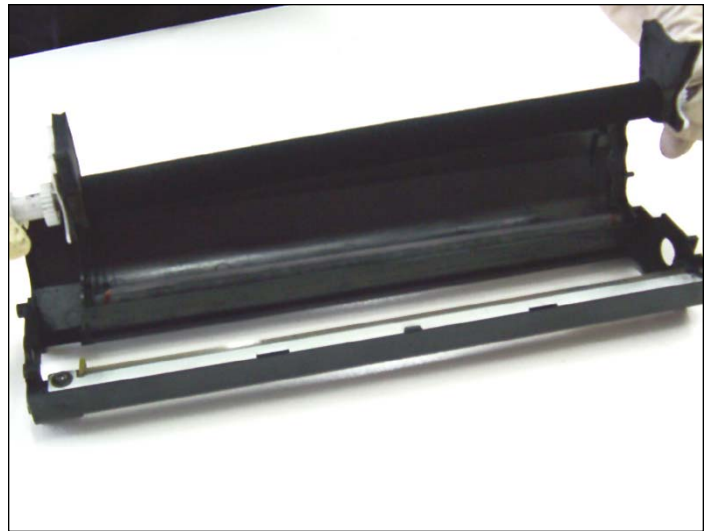
20. Sacar el rodillo de alimentación y sus componentes como se muestra.
