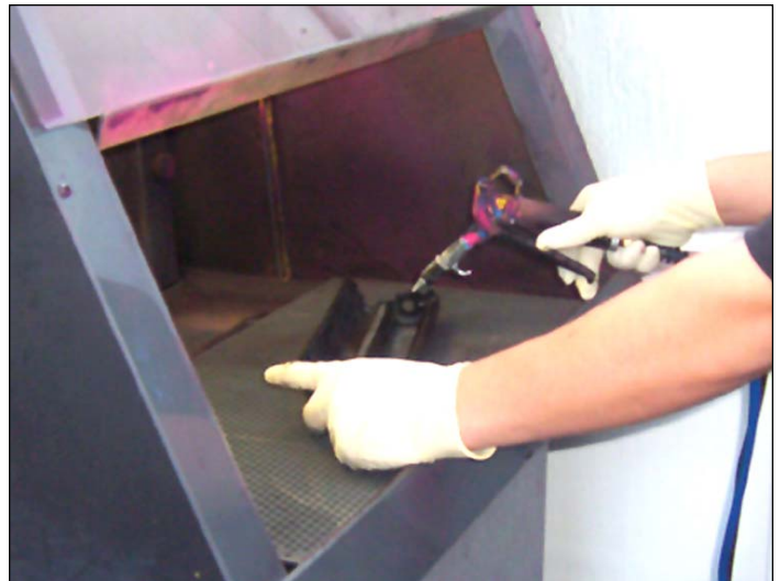
24. Limpiar con aire comprimido y montar todo nuevamente en orden inverso.
