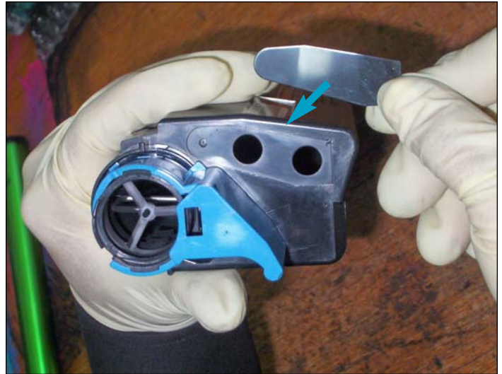
30. Después de limpiar con alcohol las aperturas en el cartucho, coloque nuevamente la tapa adhesiva.
