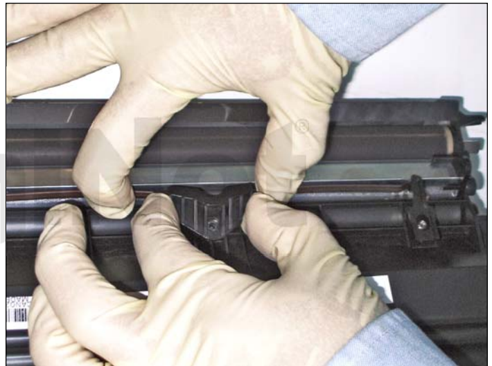
18. Mantenga el resorte presionado hacia abajo y remueva el soporte mostrado. NOTA: con la presión liberada, el resorte no puede causar daño al rodillo revelador.
