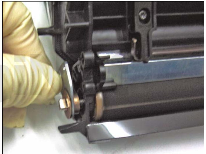
16. Ahora, remueva la placa de soporte del engranaje deslizando hacia afuera.
