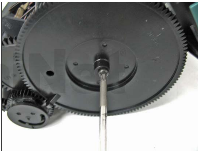
30. Para acceder al tapón de llenado, debe remover primero el engranaje guía del agitador de tóner usando una llave estrella.
