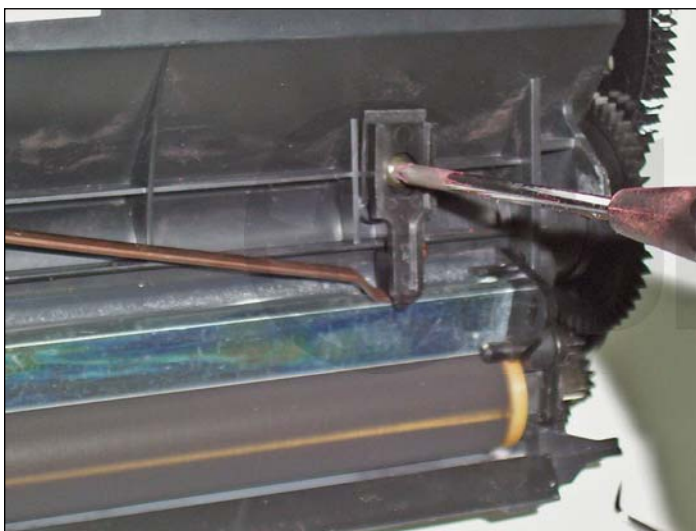
19. Remueva el soporte del resorte removiendo el tornillo que lo sostiene en su lugar.
