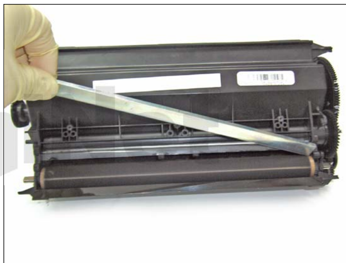
22. Remueva la barra dosificadora como se muestra.
