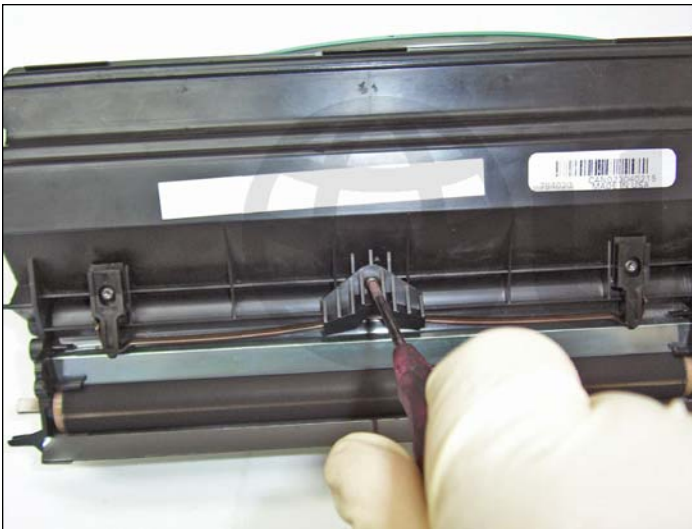
17. Primero, remueva el tornillo (mostrado) que mantiene la presión del soporte del resorte en su lugar.
