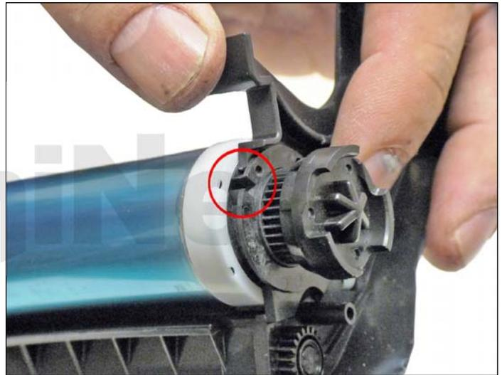
49. Coloque el cilindro en la cavidad de desperdicio de manera que las dos lengüetas de los bujes blancos estén colocadas en las ranuras inferiores y la ranura de bloqueo de los está arriba. Instale el engranaje fijo pequeño.
