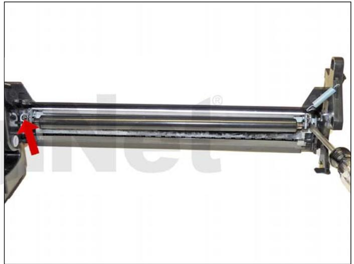
16. Instale el ensamble de la cuchilla limpiadora/PCR y sus dos tornillos.
