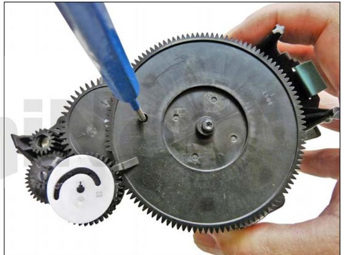
48. Instale el engranaje grande y el tornillo (torque). El agujero en el engranaje grande debe estar alineado con el agujero del engranaje pequeño (#1). Use un cincel para alinearlos. Le ayudara a mantener los engranajes ligeramente arriba del resto del tren del engranaje mientras alinea los agujeros.
