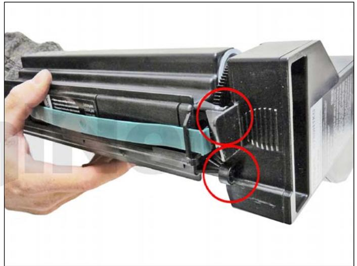
51. Coloque la cavidad de suministro en la cavidad de desperdicio. Asegúrese que la lengüeta superior en la cavidad este colocada en la ranura en la parte superior de la cavidad de desperdicio.
