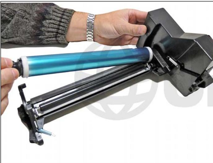
5. Levante y saque el cilindro de la cavidad de desperdicio.
