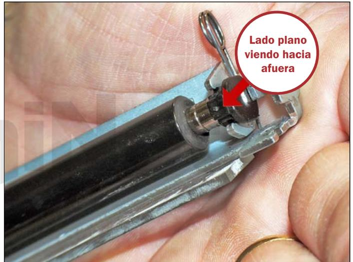
13. Coloque los resortes como se muestra, e instale el PCR limpio.
