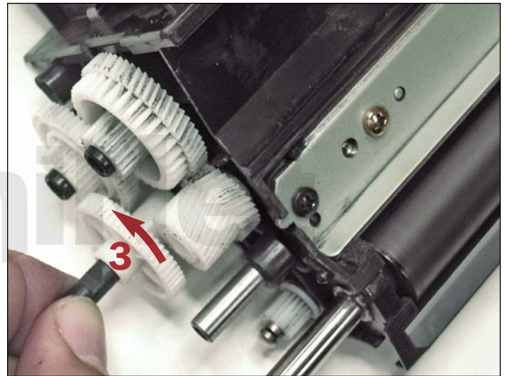
6. Girar el engranaje externo (#3) en sentido anti horario hasta que destrabe.
