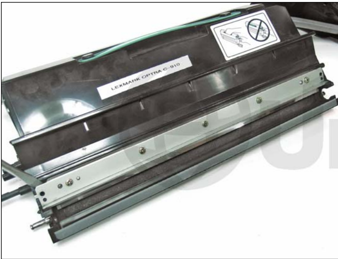
26. Con un pequeño desarmador plano levantar apenas una punta de la cuchilla para luego agarrarla con los dedos.
