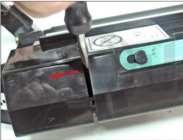
16. Con un desarmador pequeño plano separar forzando el lateral como se muestra.
