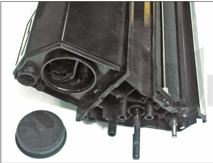
34. Tapon del deposito extraído.
