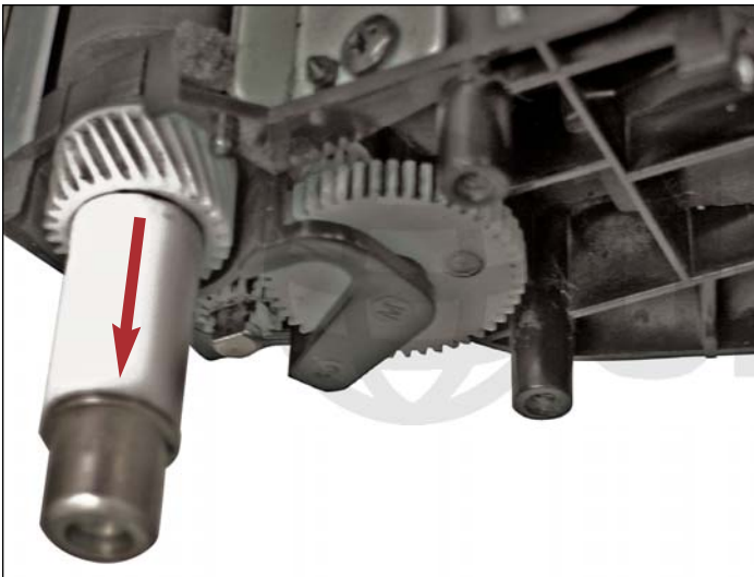
17. Deslizar primero el engranaje y el buje de bronce del eje como se muestra.
