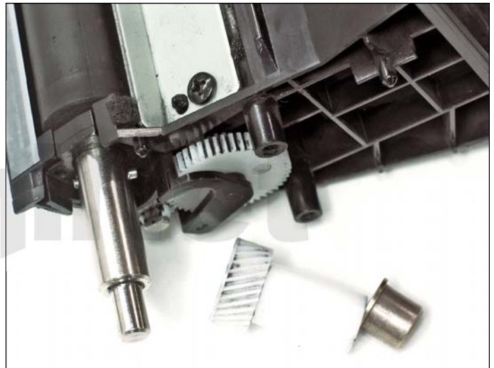
17. Deslizar primero el engranaje y el buje de bronce del eje como se muestra.
