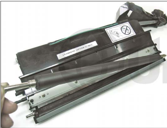
24. Levantar el rodillo de un extremo y luego del otro.
