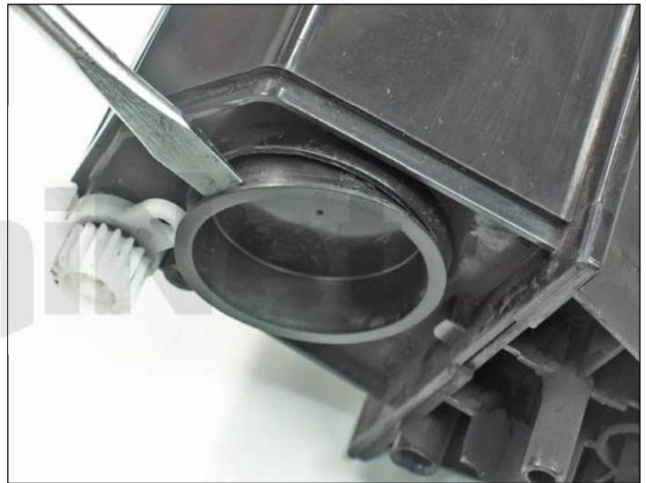
33. Sacar el tapon con un desarmador plano como se muestra.
