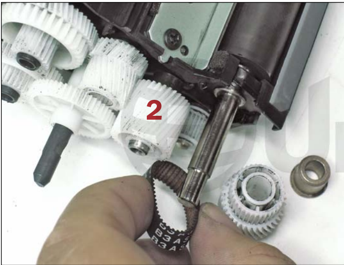
5. Sacar la correa motriz y el engranaje (#2) como se muestra.
