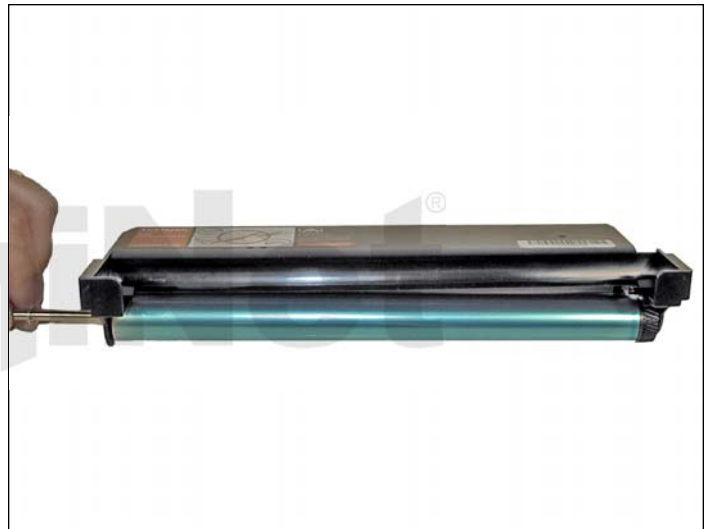
29. Deslice hacia afuera el eje del OPC.
