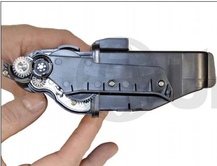
24. Instale la cubierta del engranaje y los dos tornillos.
