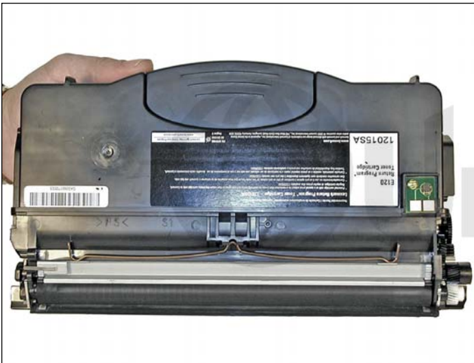
22. Instale el resorte de la cuchilla dosificadora.
