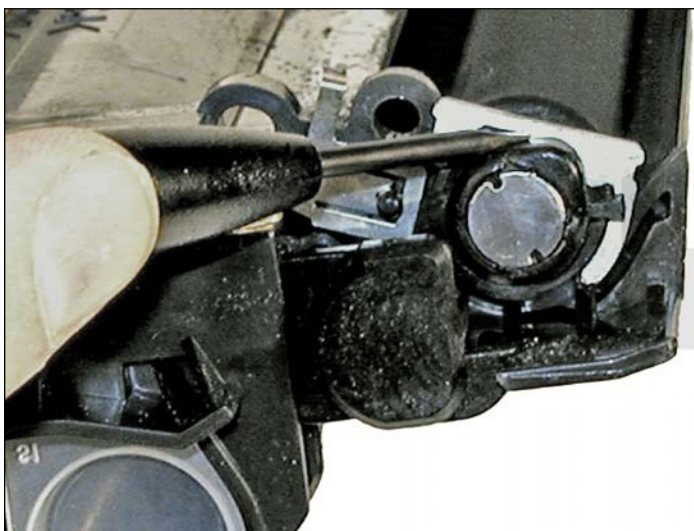
12. Con un desarmador pequeño plano de joyero, libere el candado metálico del buje del rodillo revelador.
