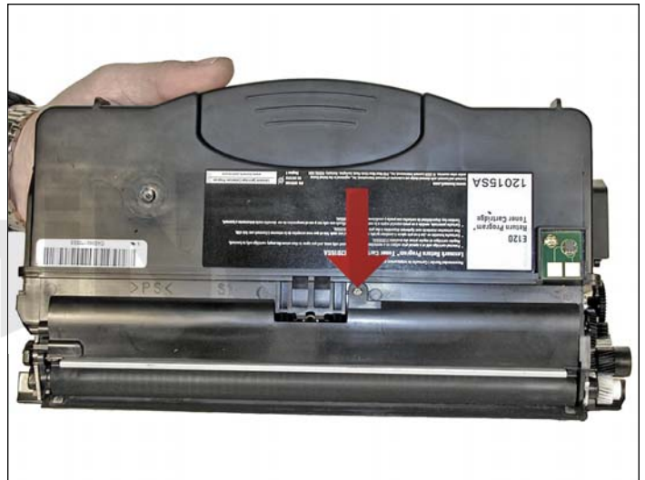
23. Instale la cubierta del rodillo revelador y el tornillo.
