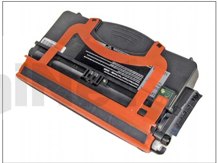
27. Si tiene la cubierta protectora para el cartucho, envuelva el cartucho como se indica. Esta cubierta protege al rodillo revelador de posibles daños. Se encuentran en desarrollo cubiertas aftermarket.
