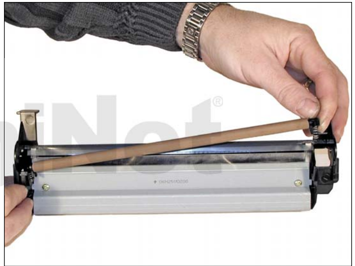
31. Desde el lado derecho (engranajes), retire el ensamble del PCR (el resorte que lo sostiene debe salir con él).
