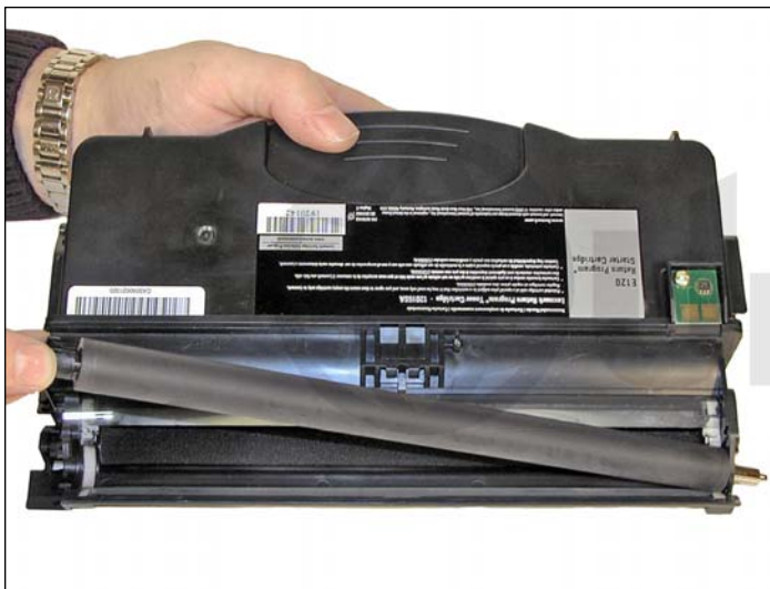
14. Saque el rodillo revelador del cartucho.
