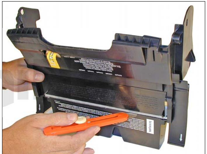
10. La cuchilla posee un sello de espuma en su parte trasera que debe ser cortada con una navaja para separarla del plástico.
