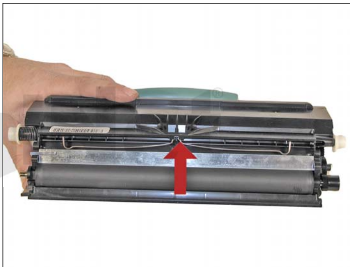
3. Libere el muelle de la cuchilla dosificadora. La cuchilla dosificadora es de un nuevo tipo y quedará suelta. Limpiar con solvente si se notan incrustaciones de tóner. Dejar la cuchilla aparte.
