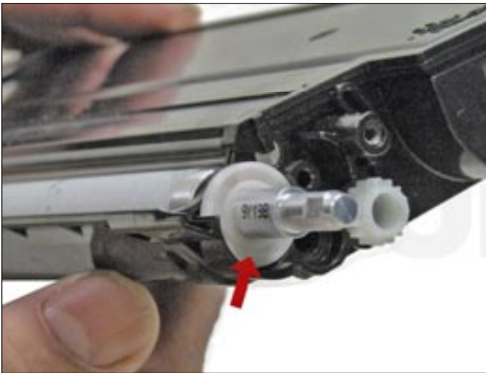
11. Sacar los rolines blancos en ambos extremos del rodillo magnético.
