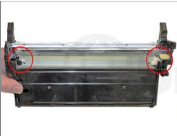
33. Montar nuevamente los soportes ya limpios del PCR y Rodillo de limpieza de PCR.
