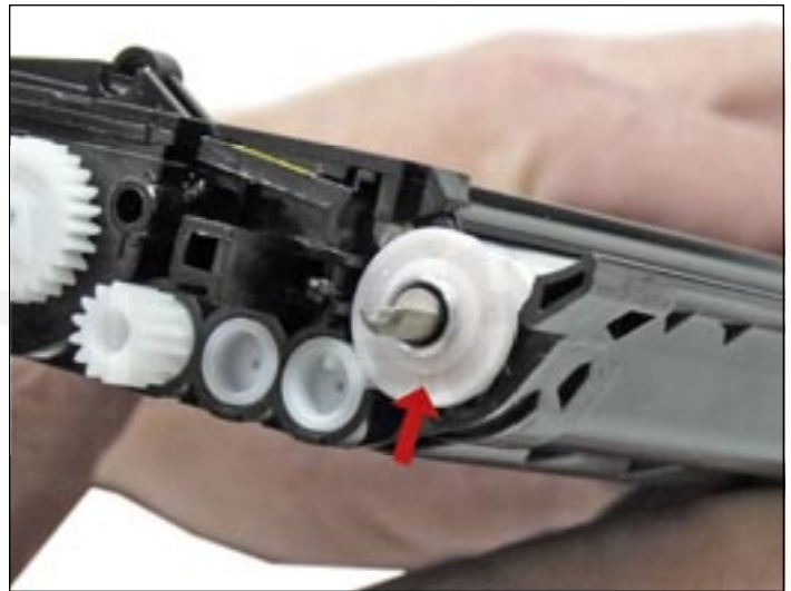
11. Sacar los rolines blancos en ambos extremos del rodillo magnético.
