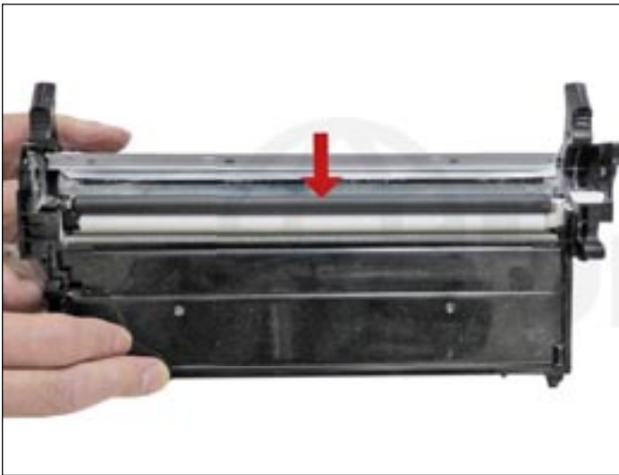
35. Montar el PCR limpio. Aplicar una pequeña cantidad de grasa conductiva en el soporte negro.
