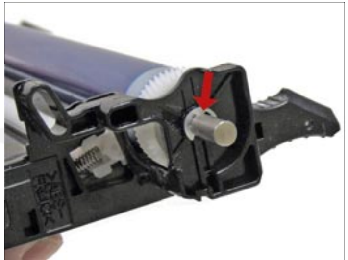
38. Montar el aro de seguridad "E".
