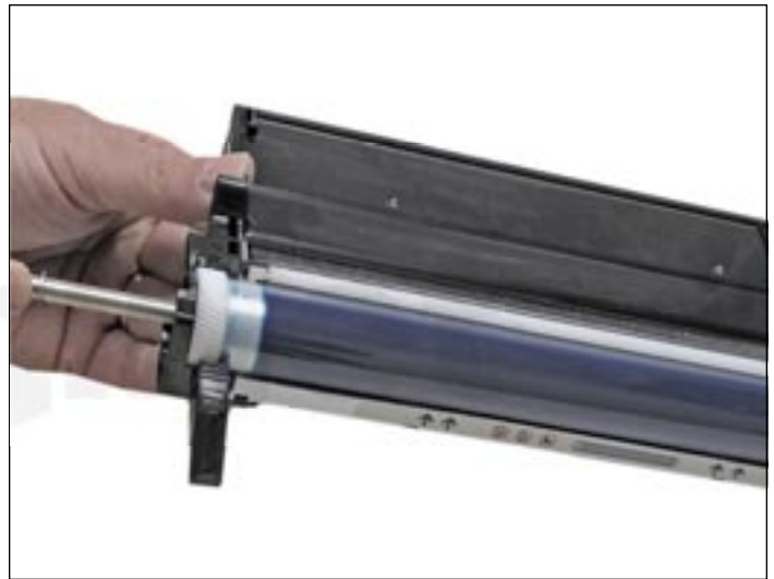
24. Extraiga el eje desde el lado del engranaje del OPC para no dañar el contacto interno de descarga a tierra.
