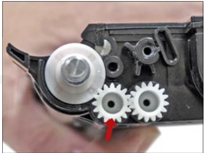
18. Montar ahora el engranaje del sinfín asegurando que quede correctamente puesto y que sus dientes engranen correctamente para evitar manchas en la impresión.
