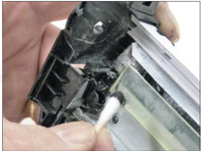
32. Limpiar los soportes de PCR y Rodillo con un hisopo y alcohol isopropílico.
