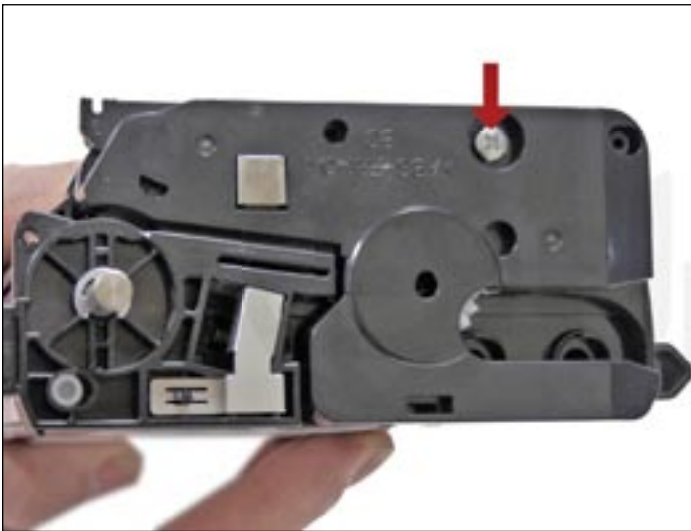
2. Sacar tornillo de la tapa lateral negra lado contactos.
