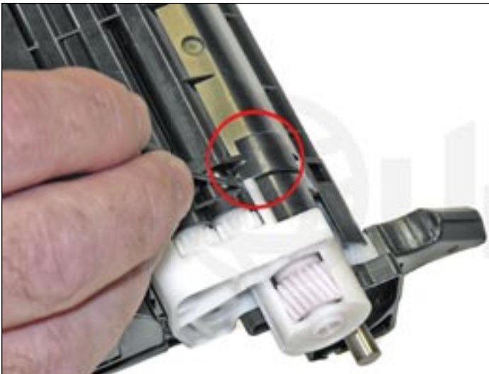
4. Retirar el lateral blanco hacienda palanca sobre la lengüeta como se muestra.
