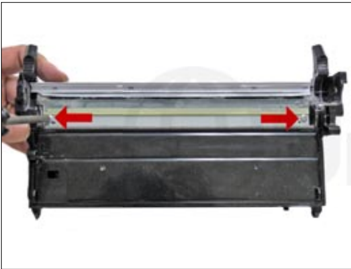
31. Recubrir el borde de trabajo de la cuchilla de limpieza con su lubricante favorito e instale la misma en su lugar con sus dos tornillos.
