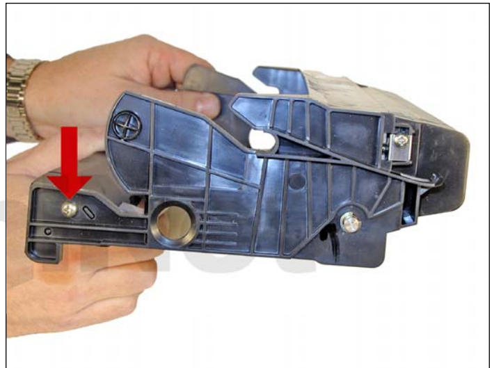
14. Instale el ensamblaje de la manija/candado del cartucho y sus dos tornillos. Sólo para asegurarse que todo este ensamblado adecuadamente y lubricado, gire el cilindro por medio del engranaje grande en la dirección adecuada, esto es siempre una buena idea como revisión final antes de instalar el cartucho en su impresora de pruebas.
